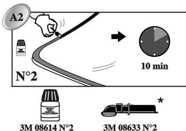
**Nota:** si la temperatura en el taller es inferior a 15°C, dejar secar la imprimación durante más tiempo hasta 20 minutos para obtener una preparación de superficie adecuada
